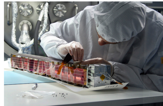
Ogon deorbitacyjny PW-Sata podczas integracji. PW-Sat deorbit tail during integration. (Credit: A. Kotarba)
